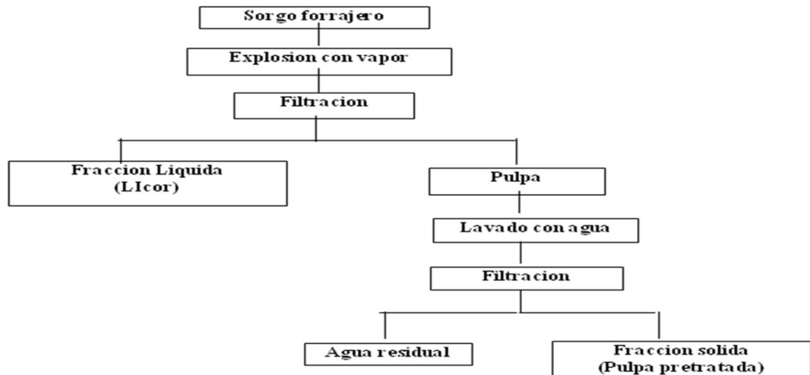
Fig7. Diagrama de flujo del pretratamiento por explosión con vapor a escala de laboratorio
